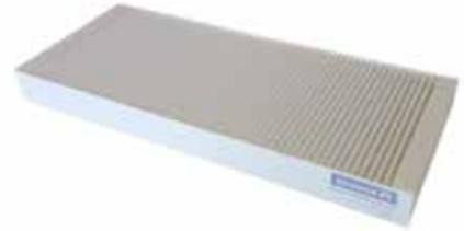
В качестве опции можно установить картриджный фильтр F7 (фильтр тонкой очистки). Данный тип фильтров задерживает пыльцу и мельчайшие частицы. Фильтр F7 рекомендуется для людей, страдающих аллергией на пыльцу. Но поскольку такой фильтр имеет более узкие отверстия и обладает большим сопротивлением к потоку, его установка будет влиять на эффективность работы системы.
